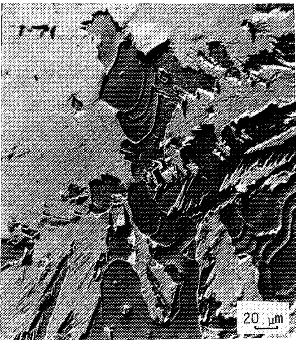
c - Joints d'interphase facettés et joints de grains lisses en l'absence de seconde phase, après maintien de 24 h à 600°C puis refroidissement lent.
