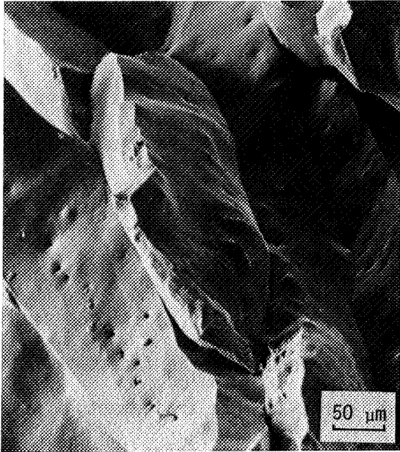
Fig. 36. Joints de grains d'un alliage de nickel pur à 1,5 % d'antimoine, brut d'élaboration.
