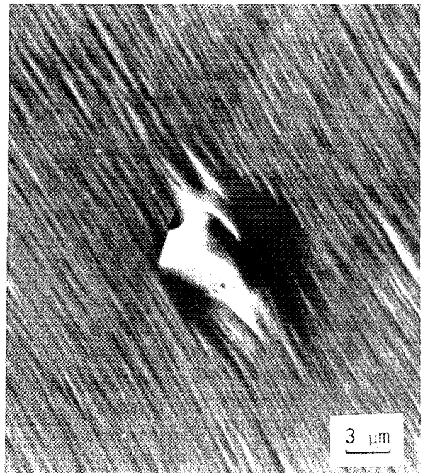
Fig. 52. Plaquettes de sulfure dans des joints de grains striés et facettés d'un alliage de nickel pur à 90.10^{-4} % de soufre, homogénéisé puis revenu 15 h à 600^{\circ}\text{C} .
