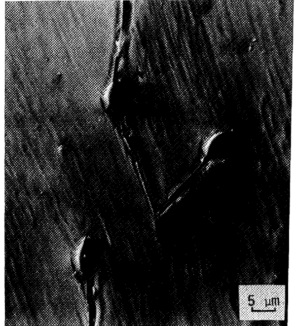
Fig. 97. Précipités intergranulaires dans un alliage de nickel INCO à 65.10^{-4} % de cuivre et 400.10^{-4} % de soufre, maintenu 20 j à 1200^{\circ}\text{C} puis trempé.
