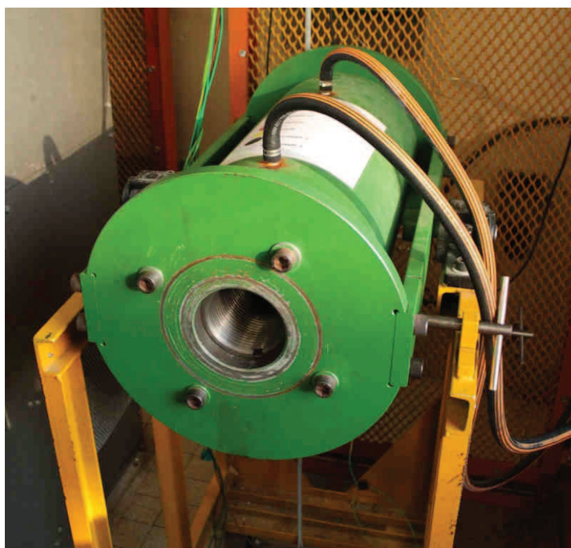
Figure III- 1 : Autoclave Gros Vert, en position horizontale pour charger le four et l'obturbateur.
