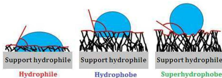
*Figure 6 : Représentation de l'angle de contact d'une goutte d'eau déposée sur support rugueux et poreux [70].*
