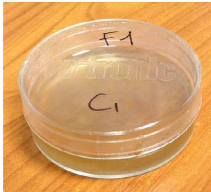
*Figure 93 : Cuvette Rotronic contenant la formulation F1 à une concentration en eau C<sub>1</sub>.*
