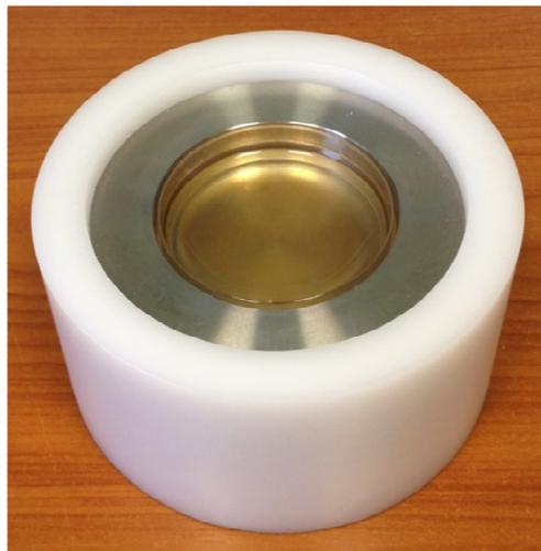
*Figure 94 : Cuvette placée dans le support aluminium-Téflon thermostaté.*
