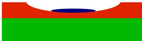
*Figure 86 : Représentation d'un cratère d'un film F5 (rouge) déposé sur du verre (vert), contenant la quantité de conservateur (bleu) présente initialement dans la gouttelette.*
