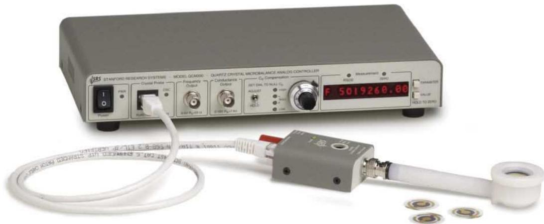
*Photographie de la microbalance à cristal de quartz, des lames de quartz et de son générateur [2].*
