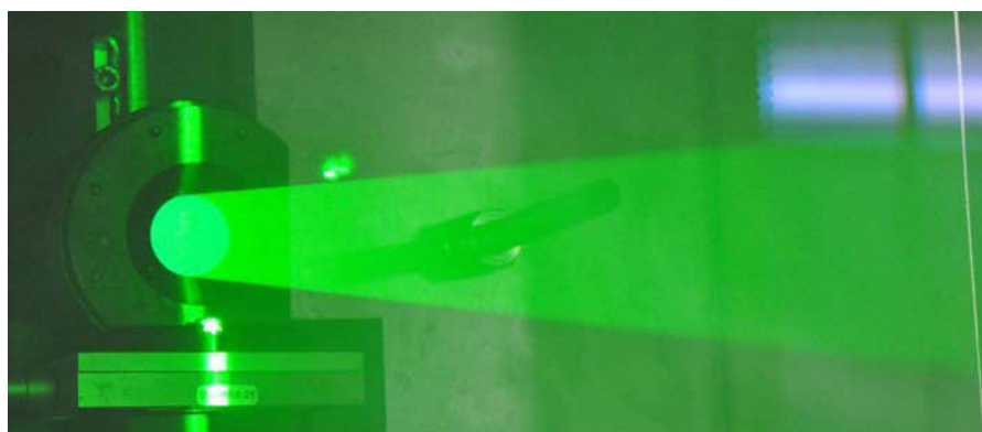
Figure 39 : Photographie du miroir placé dans la cuve de BERGAME, réfléchissant la nappe laser
