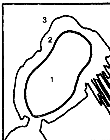
- b - Alliage Fe-Cr-Co (Cr:14%; Co:1,9%; C: 120 \cdot 10^{-4}\% ) trempé à l'air à partir de 1220^\circ\text{C} (G=700).
