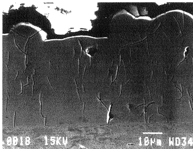
figure 37 : Coupe micrographique d'un échantillon en acier, chromé à 40°C. Dépôt brut de chrome observé au MEB.
