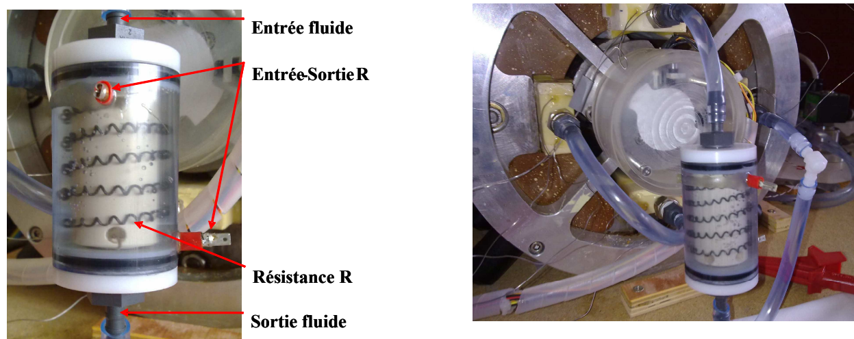
FIGURE III.26- Vue détaillée et d'ensemble de l'échangeur E2
