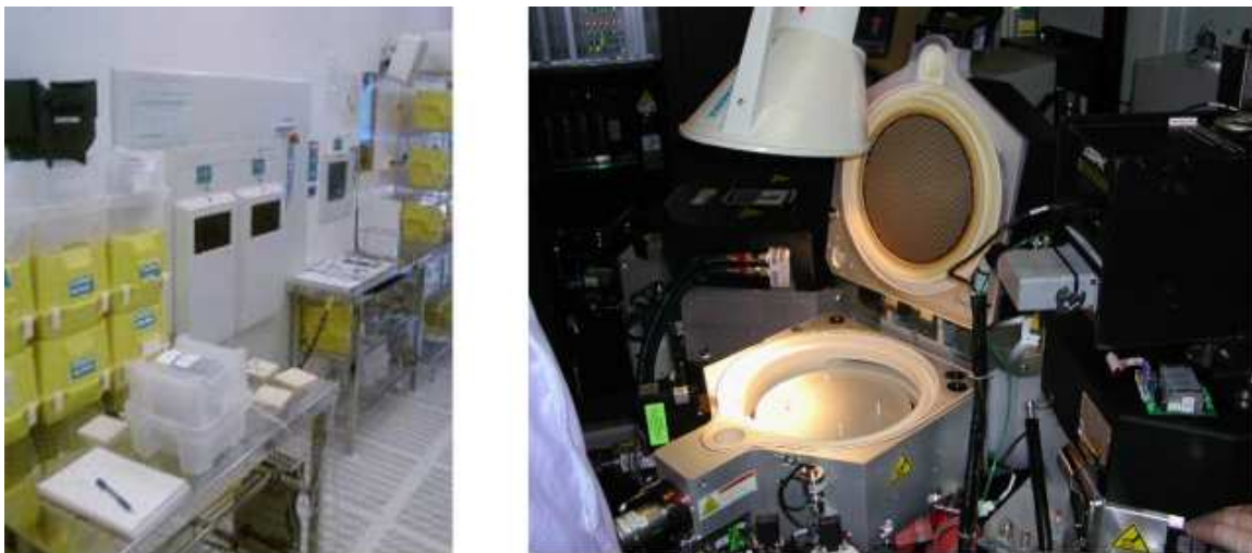
Figure 4.1 : A gauche : Photo de la CENTURA 5200 D coté sas ce chargement en salle blanche. A droite : la chambre de croissance ouverte de l'autre coté de la façade (coté « doigts gris »)
