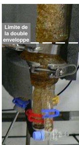
Figure 81: Agrandissement du pied de l'unité de désorption réactive avec indication de la limite de la double-enveloppe.
