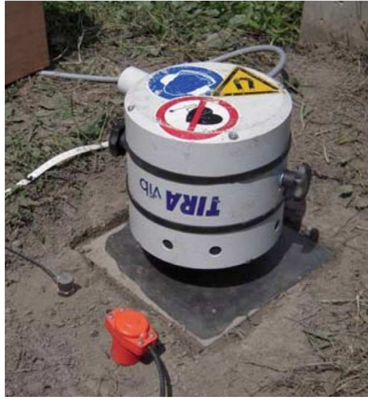
FIGURE 5.27 – Pot vibrant de l’IFSTTAR utilisé dans le cadre d’acquisitions de terrain, notamment sur le site test de Grenoble
