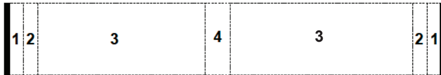
Figure 1.31 : Schéma de la structure multicouche d'un PA66GF30 : (1) épaisseur 10µm, FV non orientées, structure cristalline non sphérolitique ; (2) épaisseur 10µm, FV orientées, structure cristalline non sphérolitique ; (3) FV orientées, structure cristalline sphérolitique ; (4) (2) épaisseur 500µm, FV moins orientées, structure cristalline sphérolitique. (Mourglia, 2009).
