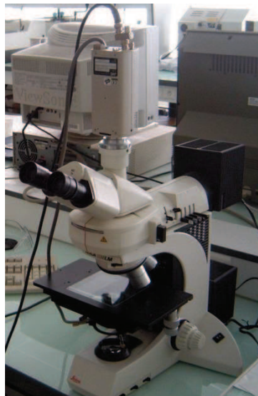
Figure 2.11 : Microscope optique LEICA DMLN® et système vidéo LEICA Q5001W®
