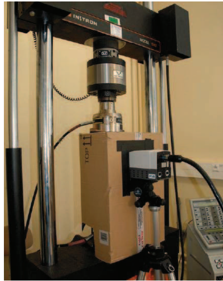
Figure 2.49 : Dispositif expérimental utilisé pour les mesures thermiques sur INSTRON® (Le Saux, 2010)
