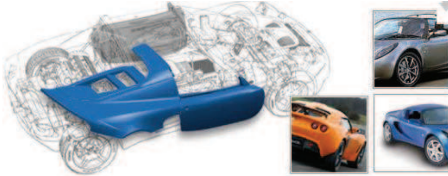
Figure 1.3: Carrosserie Lotus "Elise" réalisée en RTM. (Source SORA Composites)
