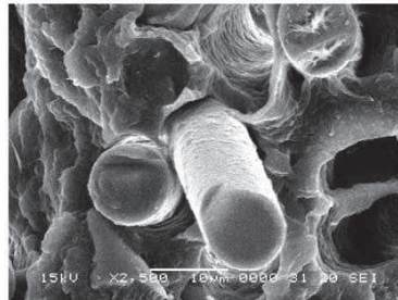
Figure 1.25 : Faciès de rupture d'un PA66 renforcé obtenu par MEB. (Fu, 2005).
