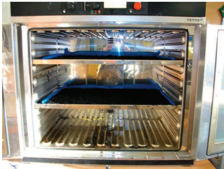
Figure 2.2: Dispositif d'étuvage du PA66GF50
