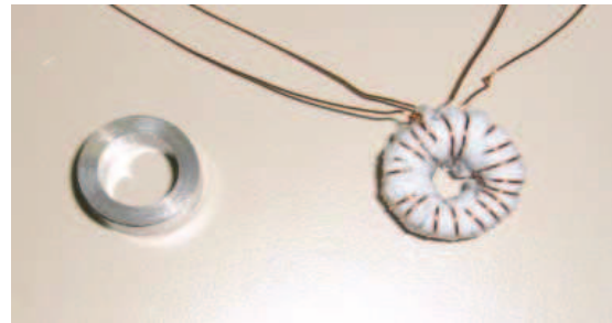
Figure 3.2.b. Vitroperm 800F avant (à gauche) et après bobinage (à droite) par le ruban en fibre de verre
