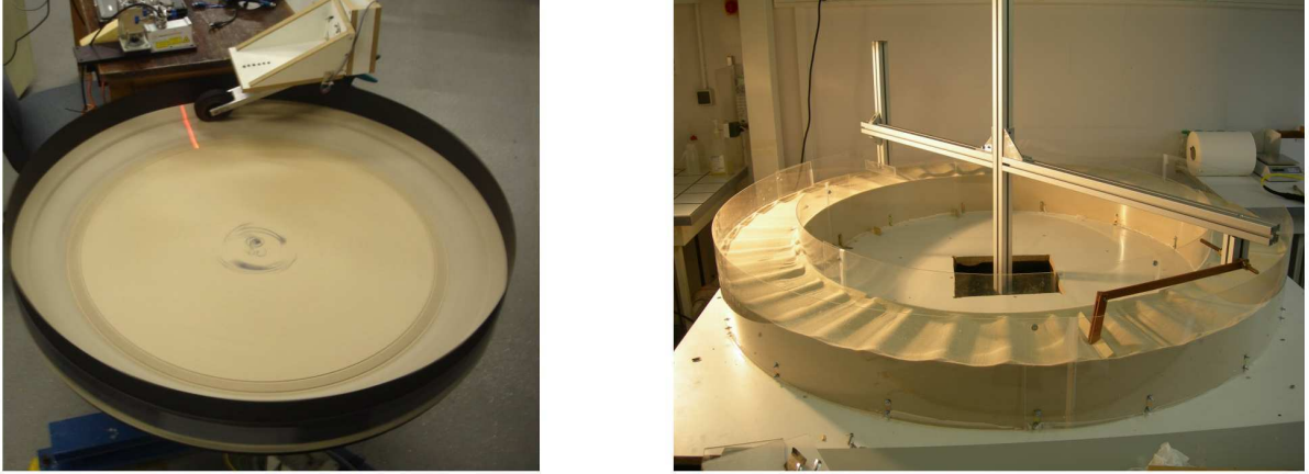
FIGURE 2.3 – Photographies des deux montages expérimentaux. À gauche, l’expérience réalisée à Cambridge, une table tournante sur laquelle est déposée une couche de grains est mise en rotation. L’avantage de ce dispositif est que la roue n’est pas en rotation autour de la piste et donc il est facile de l’instrumenter. Cependant, à cause de la force centrifuge, les grains sont éjectés vers le bord extérieur de la table tournante et le lit de sable n’est pas horizontal. À droite, l’expérience réalisée à Lyon. Ici, la piste est fixe et c’est la roue qui se déplace, il est donc plus compliqué de l’instrumenter. Par contre, la piste n’est pas soumise à la force centrifuge et est deux fois plus longue qu’à Cambridge.
