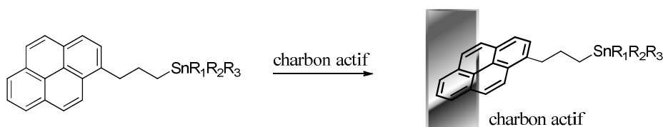
Schéma 125 – Interaction du groupement pyrényle avec le charbon actif
