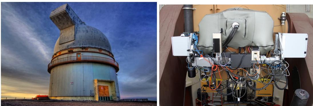
FIGURE 2.1 – À *g.* : le télescope UH88 de 2,2 m de l'Université d'Hawaï (source) ; à *dr.* : vue d'ensemble de SNIFS monté sur le port Cassegrain replié Sud du télescope (source).
