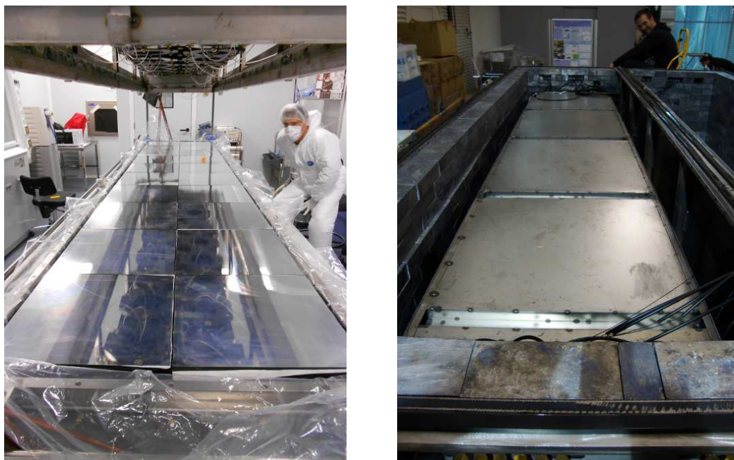
Figure 2.19: Montage et installation de BiPo 3 au Laboratoire Souterrain de Canfranc ; à gauche les modules optique de la partie basse d'un module sont en phase d'alignement en salle propre ; à droite le module fermé dans la cuve en fer avec le blindage de plomb.
