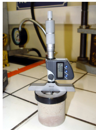
Figure 4.7 - Matériel de mesure de la planéité.
