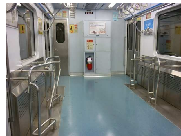
Aménagement pour vélos dans une rame de métro, Incheon, Corée du Sud, 09/09/2011.
