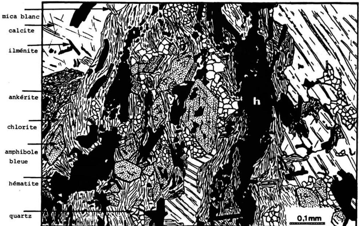
Fig. 12 - lame mince d'une "ophicalcite" (échantillon B 83-125 du niveau 10 de la figure 11).
