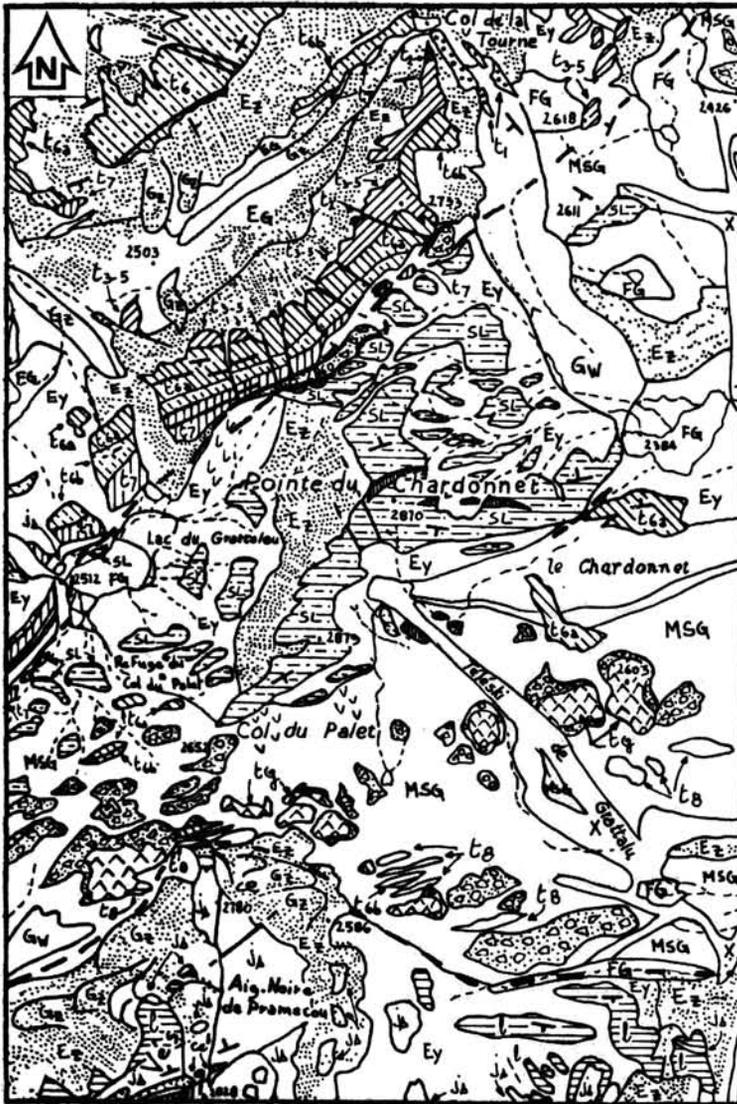
Fig. 9 - Carte géologique à 1/25000 des environs de la nappe des Schistes Lustrés et de la nappe des Gypses (SW du Lac de Tignes).
