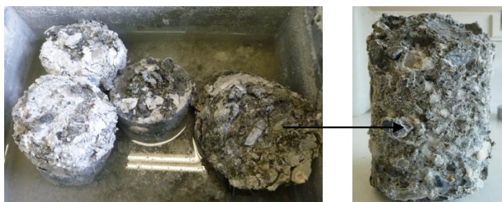
Figure I-5 : Exemple de bétons sans cohésion due à la formation de thaumasite (photo LCPC)
