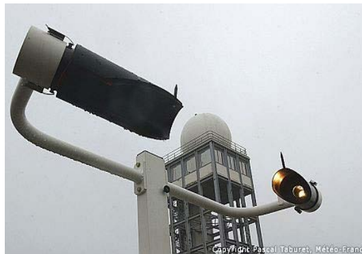
FIGURE 3.6 – Le diffusomètre utilisé pour acquérir les données de référence sur le site instrumenté de Trappes.
