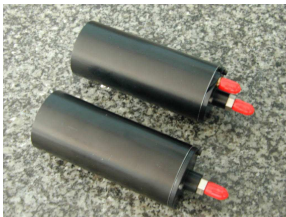
FIG. 6.6 - Photo de la tête à miroirs et des embouts à 1 ou 2 fibres
