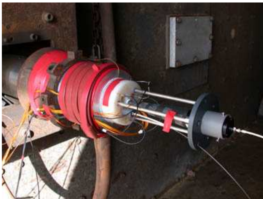
FIG. 5.4 - Montage de la cible à l'extrémité du lanceur
