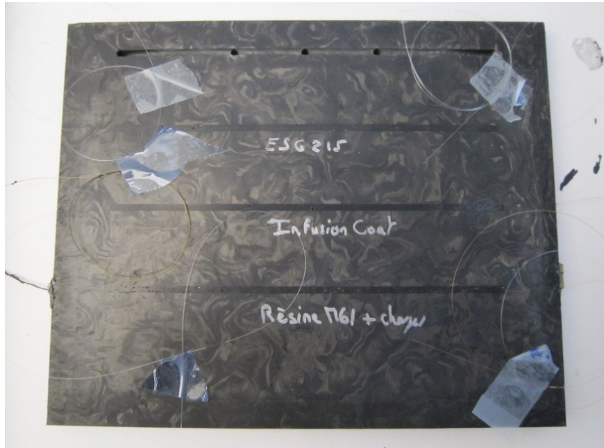
Figure 9.4 – Démonstrateur HexTool : insertion de fibre optique en surface
