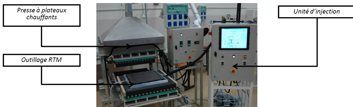
Figure 3.1 – Les équipements du démonstrateur de laboratoire
