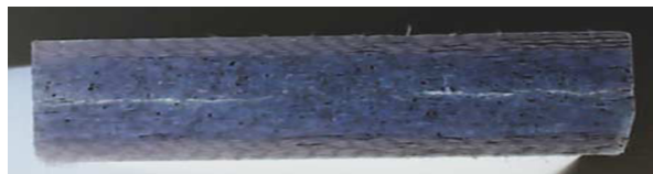
Figure 2.13 – Fissuration de la matrice lors de l'élaboration d'une pièce épaisse [220]
