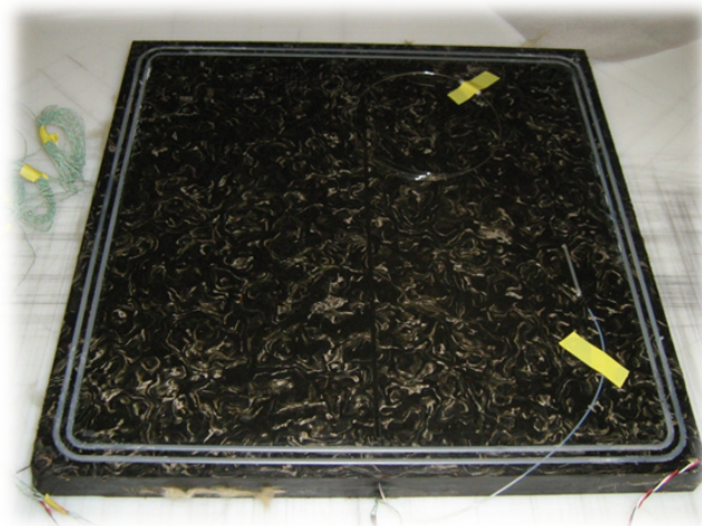
Figure 3.11 – Solution d’insertion de capteur dans l’outillage : (a) Schéma de principe ; (b) Outillage instrumenté.
