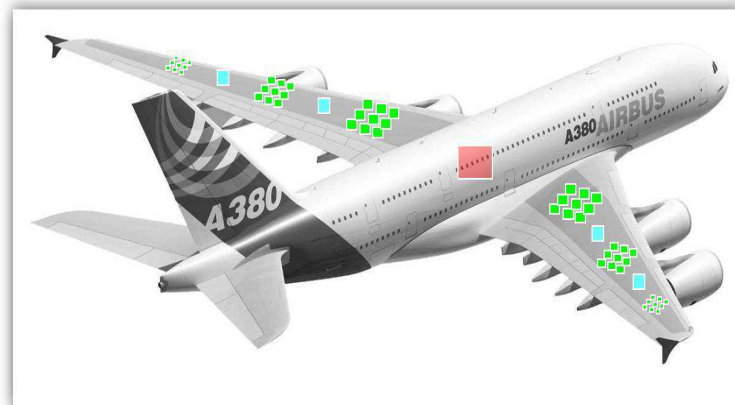
FIGURE 10 : SYSTEME SANS FIL DE MESURE D'UN PROFIL DE PRESSON AUTOUR D'UN AVION ET DE LA REPONSE MECANIQUE D'UN SATELLITE
