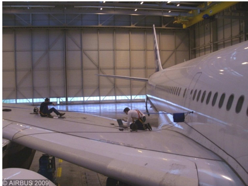
FIGURE 25 : PHOTOGRAPHIE DE L'ESSAI AVEC LES ANTENNES POSEES SUR LA VOILURE
