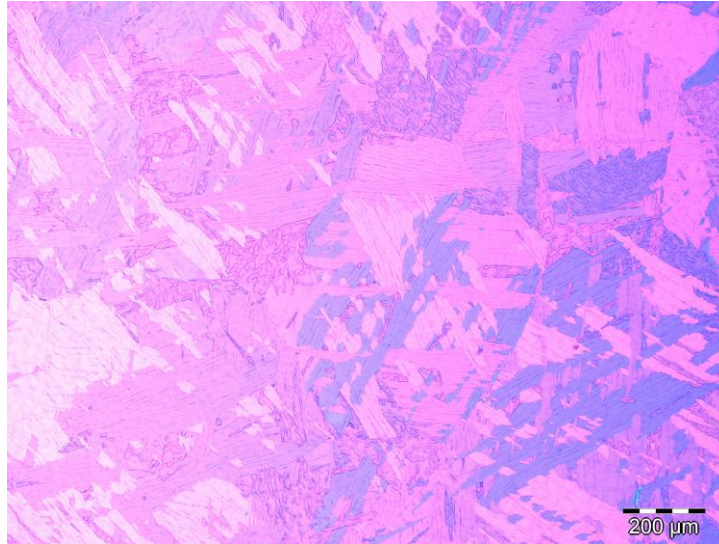
Figure II-11 : Micrographie optique en lumière polarisée d'une microstructure lamellaire de Zircaloy-4
