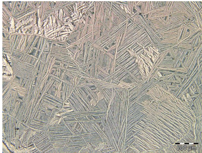
Figure II-10 : Micrographie optique en lumière blanche d'une microstructure lamellaire de Zircaloy-4 après une attaque chimique
