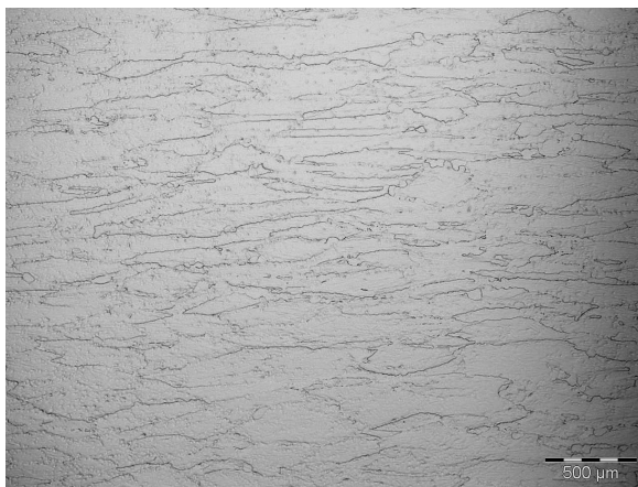
a. T = 915\text{ °C} , \dot{\epsilon} = 0,1\text{ s}^{-1} et \epsilon = 1 (refroidissement eau)
