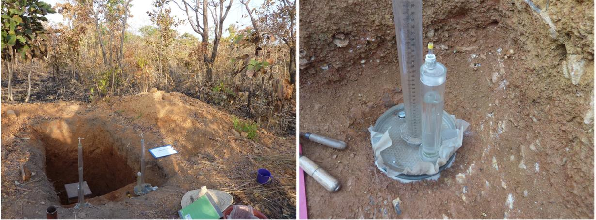
FIGURE 5.7 – Essais d'infiltrométrie à disque sur le bassin versant de l'Ara, décembre 2010
