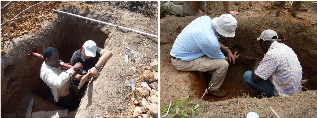
FIGURE 5.4 – Prélèvement de cylindres de densité sur le bassin versant de l'Ara, novembre 2010
