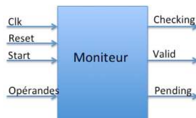
Figure II.8 : Interface de moniteur d'Horus
