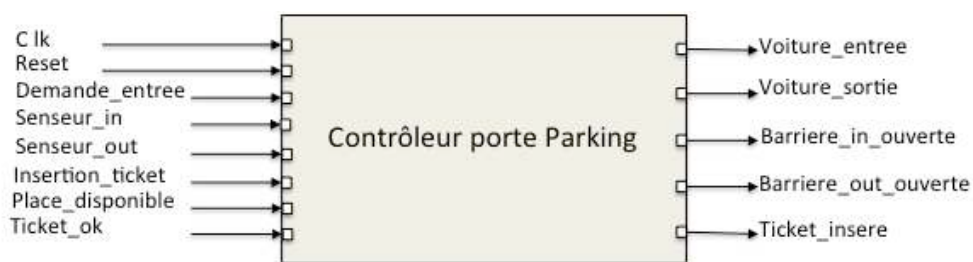
Figure II.12 : Interface du contrôleur de barrière de stationnement
