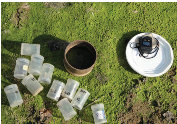
Figure 32 : Matériel expérimental pour la réalisation d'un essai Beerkan
