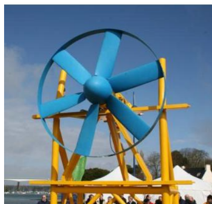
Figure I-17 : Turbine à flux axial. Hydrolienne D03 de Sabella S.A.S. Source : www.sabella.fr .
