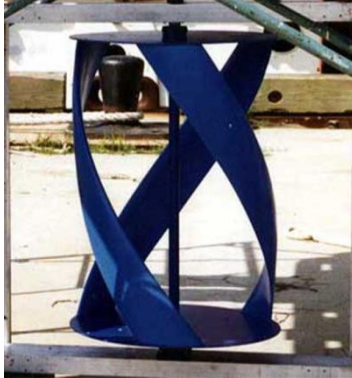
Figure II-3 : Hydrolienne Gorlov testée en 1996. Source : www.oce.uri.edu .
