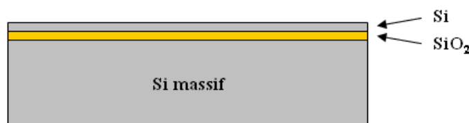
Figure 113 : Architecture d'un substrat SOI
