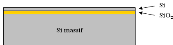
Figure 90 : Architecture d'un substrat SOI
