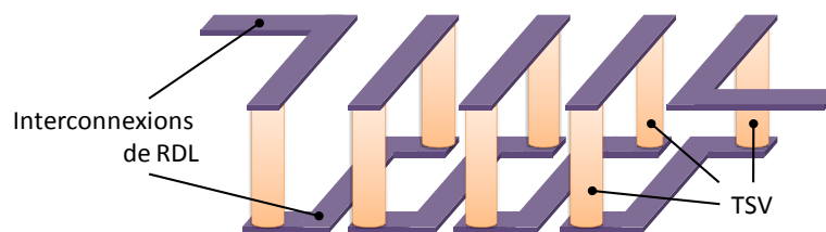
Figure c-2 : Représentation schématique d'une inductance 3D dans un substrat silicium d'interposer
