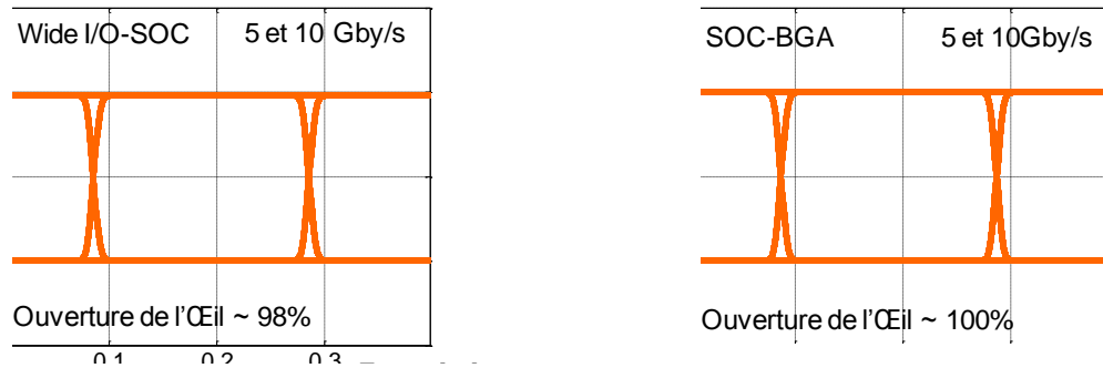
Figure 5-14 : Diagrammes de l'œil des communications Mémoire-Processeur (à gauche) et Processeur-BGA (à droite) dans le cas d'une technologie à haute densité d'intégration.
