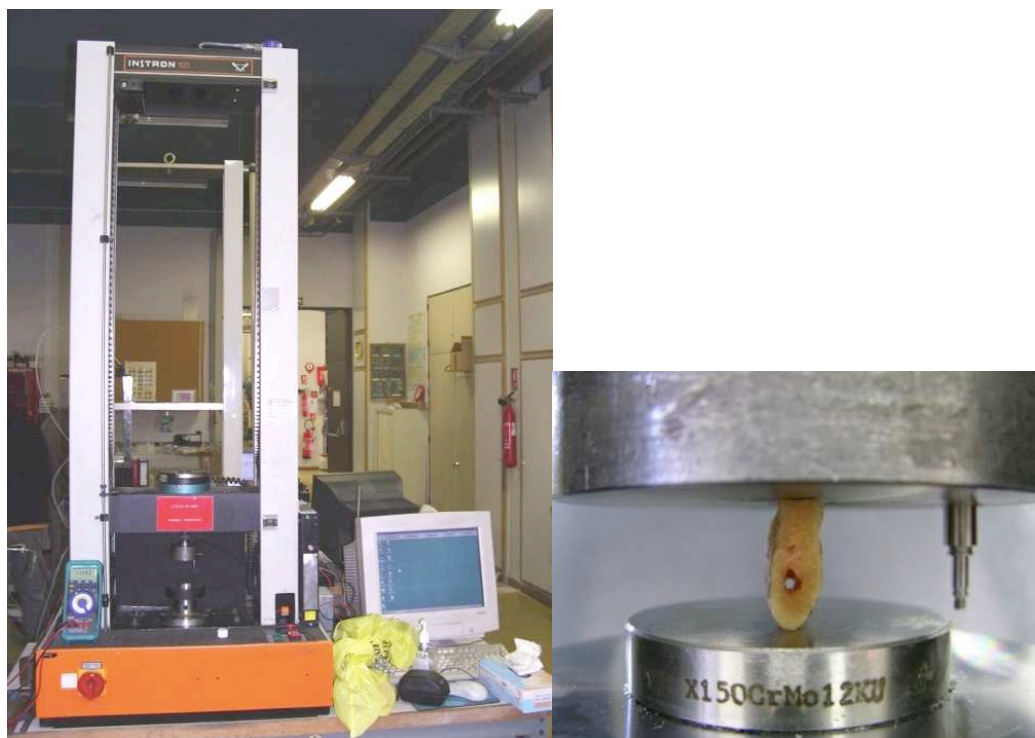
Figure 55 : Machine d'essai Instron® 1121 avec extensomètre de type LVDT
