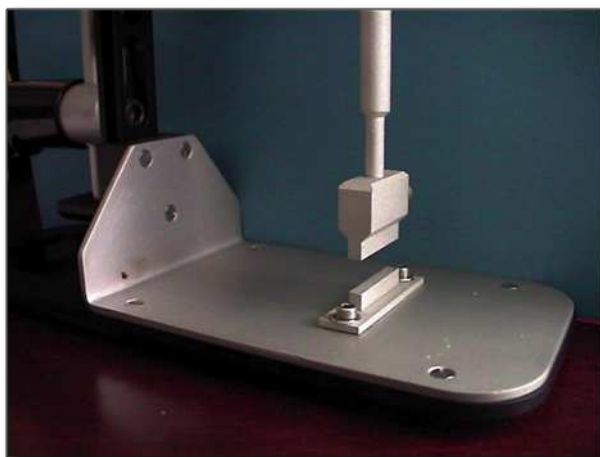
Figure 72 : Adaptation de la pince rhéobiol à l'essai de bipoinçonnement
