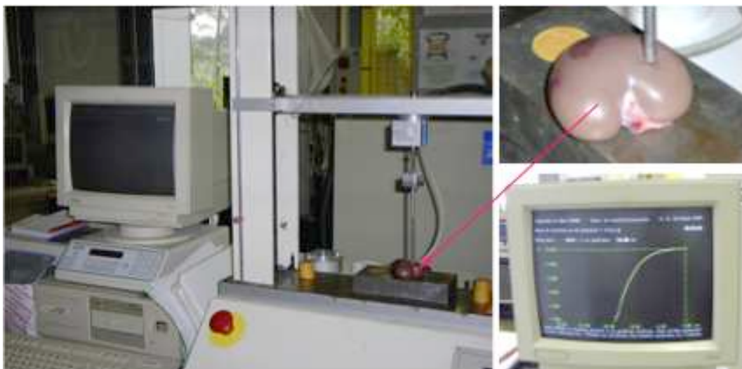
Figure 39 : Indentation expérimentale d'un rein d'agneau ex-vivo
