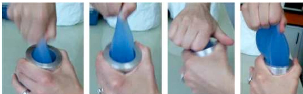
Figure 127 : Essai expérimental du passage de la prothèse à travers un anneau
