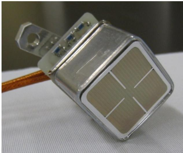
FIGURE 2.10 – Photomultiplicateur Hamamatsu R7600-06MOD-ASSY utilisé dans la TPC de XEMIS.
