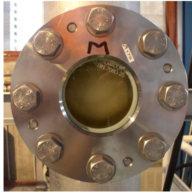
Figure 4.24 – Hydrates mixtes formés dans la colonne à bulles, vue à partir du hublot du milieu.
