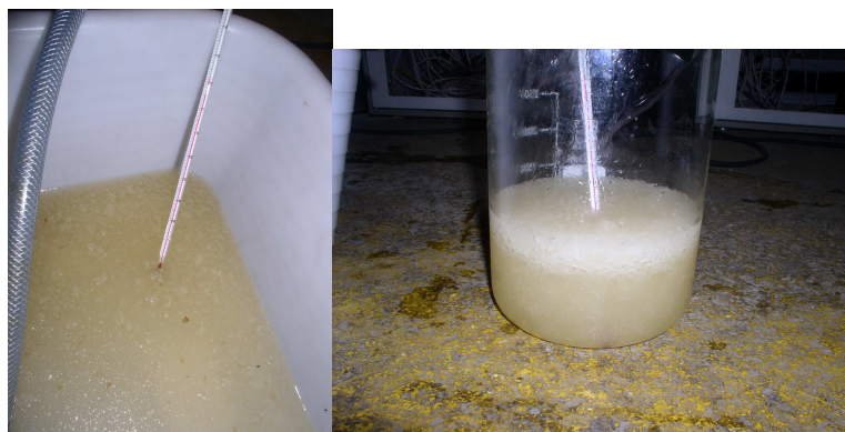
Figure 4.25 – Prélèvement d'une partie des hydrates mixtes formées dans la colonne.
