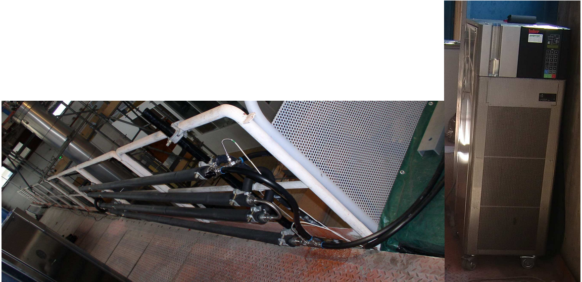
Figure 4.17 – Echangeurs de chaleur et cryostat.
