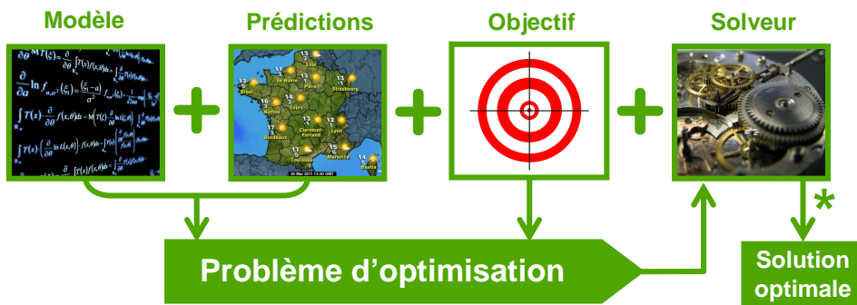
Figure A.3 Commande prédictive dans le bâtiment - principaux ingrédients
