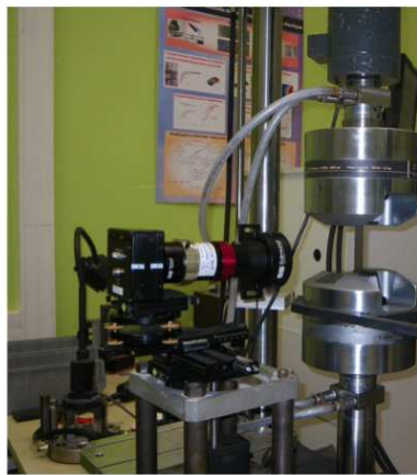
FIGURE 1.19 : Montage d'essai uniaxial classique. Un objectif télécentrique est généralement utilisé pour limiter les déformations parasites liées aux déplacements hors-plan.
