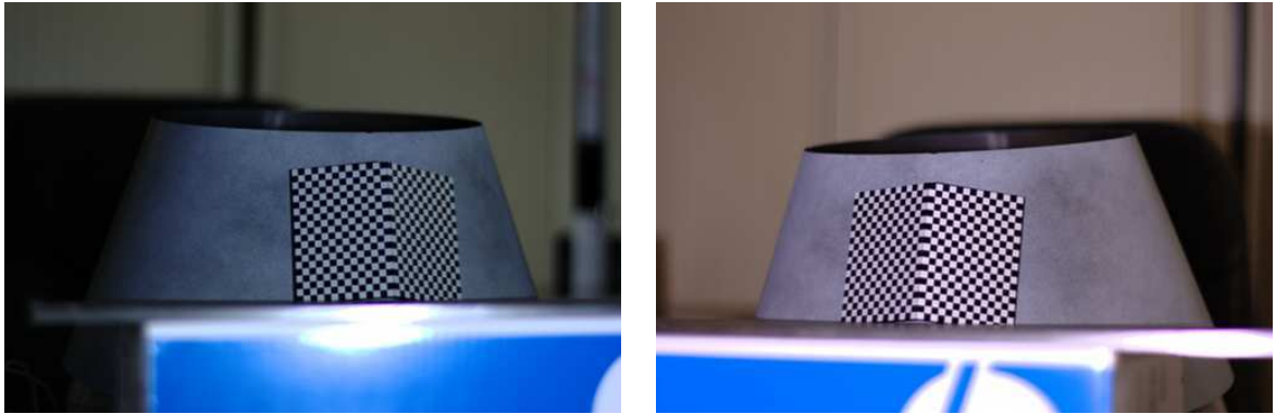
FIGURE 2.8 : Images gauche et droite de la mire de référence. Les mires couvrent ici l'essentiel de la zone de l'objet à reconstruire, même si des mires de plus grandes dimensions auraient mieux convenu.
