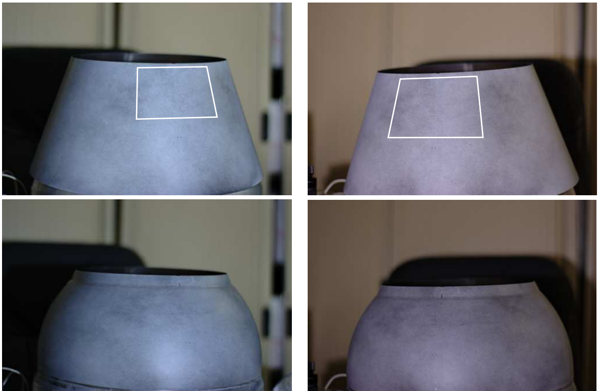
FIGURE 2.10 : Images gauche et droite du cône initial (en haut) et du TCS mis en forme (en bas). La zone d'analyse est symbolisée en blanc (taille physique réelle : environ 8 \times 8 cm).
