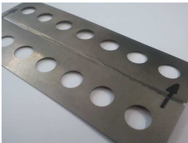
FIGURE 2.5 : Photographie de l'éprouvette de flexion après l'essai. Il est difficile d'appliquer une sollicitation uniforme dans toute la section centrale d'éprouvettes très fines : l'éprouvette flambe localement, ce qui provoque des bosses sur la section et un amorçage de fissure prématuré et localisé près des mors.
