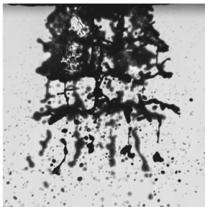
Figure 4. Atomisation primaire en sortie d'injecteur
