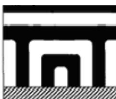
**Figure A.49** Illustration de la structure d'un film de PS-*b*-PMMA ( $M_w = 50000$  g/mol,  $f_{PMMA} = 0,47$ ,  $L_o = 36$  nm) avec une coexistence des lamelles parallèles et perpendiculaires due à l'épaisseur du film [59]
