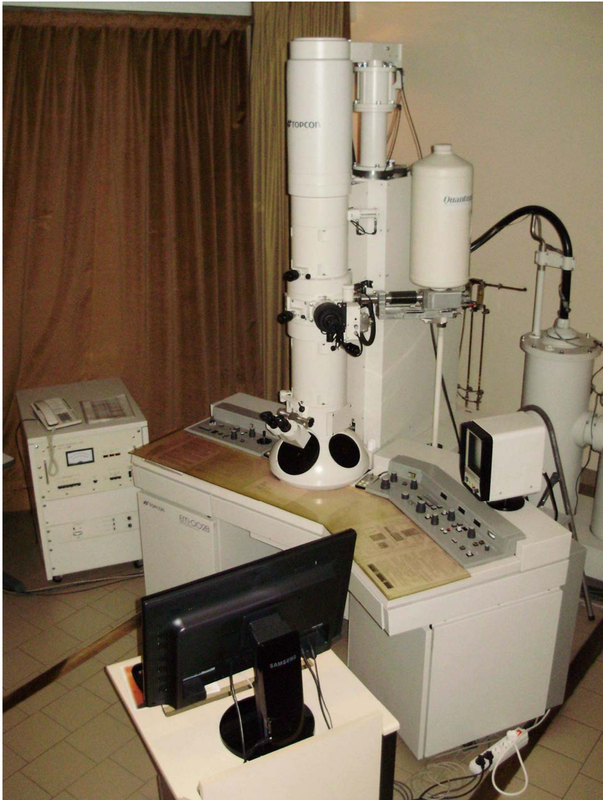
Figure 6 : Photo du microscope électronique à transmission TOPCON
