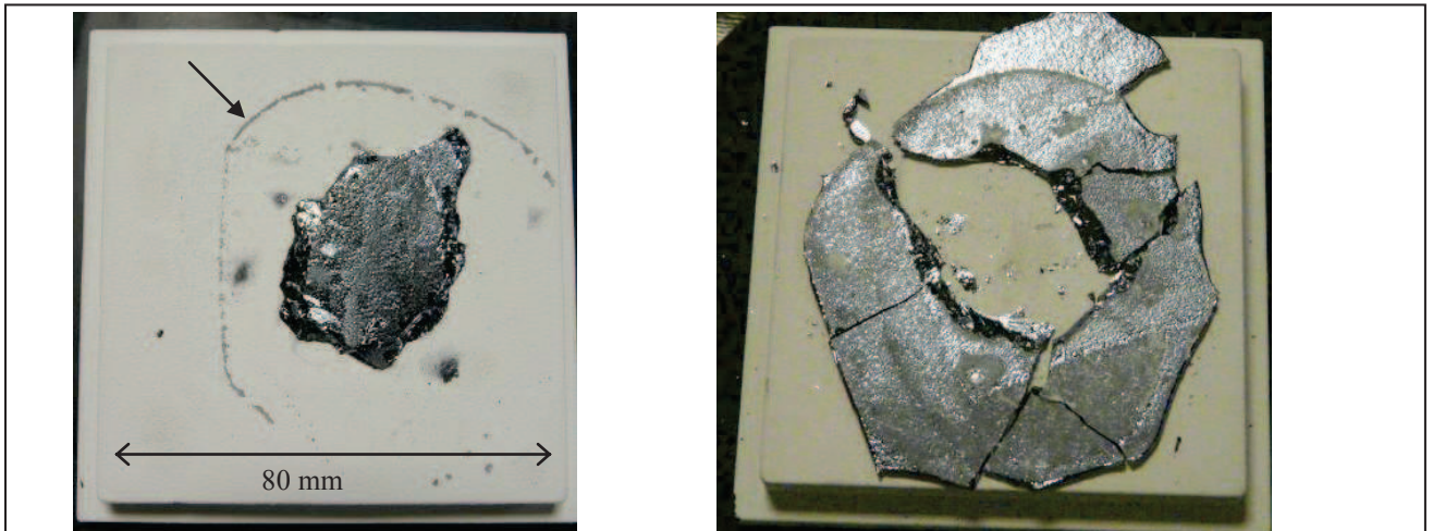
Figure 5.28 : Etat de la plaque après démoulage ; à gauche : zone de collage sur le socle (flèche = ligne triple de la coulée du Si) ; à droite : fracture de la plaque après l'avoir désencastrée de l'entretoise
