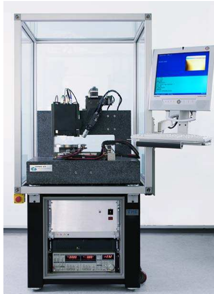
Figure 55 – Dispositif de mesure des propriétés de transport des jonctions « plein tranche » : le CAPRES.
