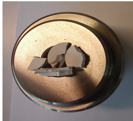
Figure A5-12 : Photo d'une pastille de Sicade ® réalisée sans solution de consolidation et pressée à 3 tonnes à la sortie de la pastilleuse.
