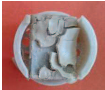
Figure A3-5 : Photo d'un échantillon après synthèse par Dry Gel Conversion : il s'agit de l'alliage d'aluminium 7075 protégé par la zéolithe ZSM-5 et immergé 4 fois dans le gel de synthèse de la zéolithe Bêta.
