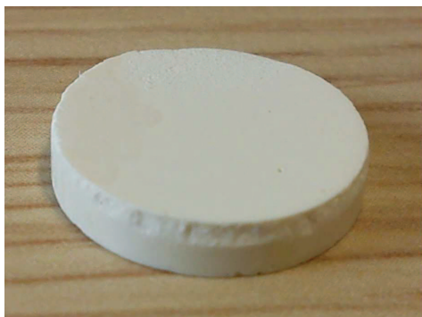
Figure A5-13 : Photo d'une pastille présentant des bords effrités
