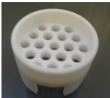
Figure A3-1 : Support en Téflon perforé conçu pour les synthèses par Dry Gel Conversion
