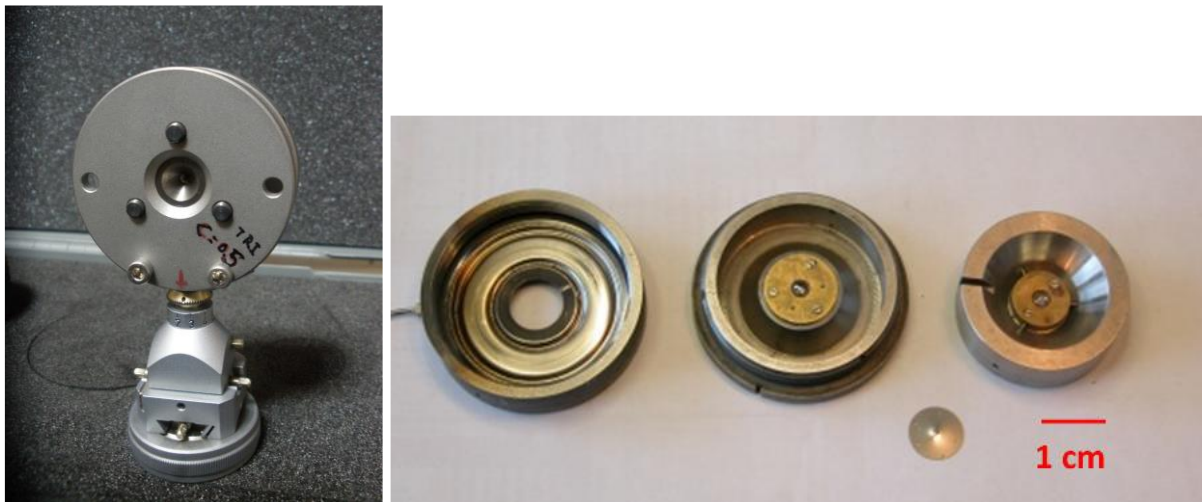
Fig. 2.7: Cellule à enclume de diamant à vis de type Almax (à gauche) et CED à membrane de type Chervin (à droite) utilisées dans les expériences sous pression de diffraction de rayons X et de spectroscopie Raman respectivement.
