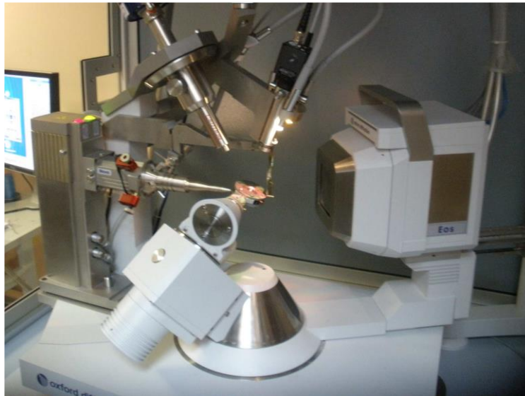
Fig. 2.13: Photo du diffractomètre Xcalibur (géométrie de Debye-Scherrer) avec une cellule à enclume de diamant montée pour une expérience sous haute pression. La source est une anode de Molybdène.
