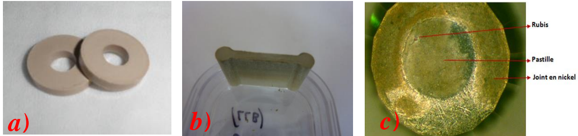
Fig. 2.5: Image de pastilles de vermiculite. a). Pastilles d'épaisseur 2mm. b). Pastille d'épaisseur 2 mm et de hauteur 12 mm, mise en forme pour la diffusion de neutrons aux petits angles. c) Pastille d'épaisseur 300 \mu\text{m} , mise en forme dans un joint en nickel pour la diffusion de rayons X aux petits angles.
