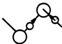
a) vibration d'extension antisymétrique
