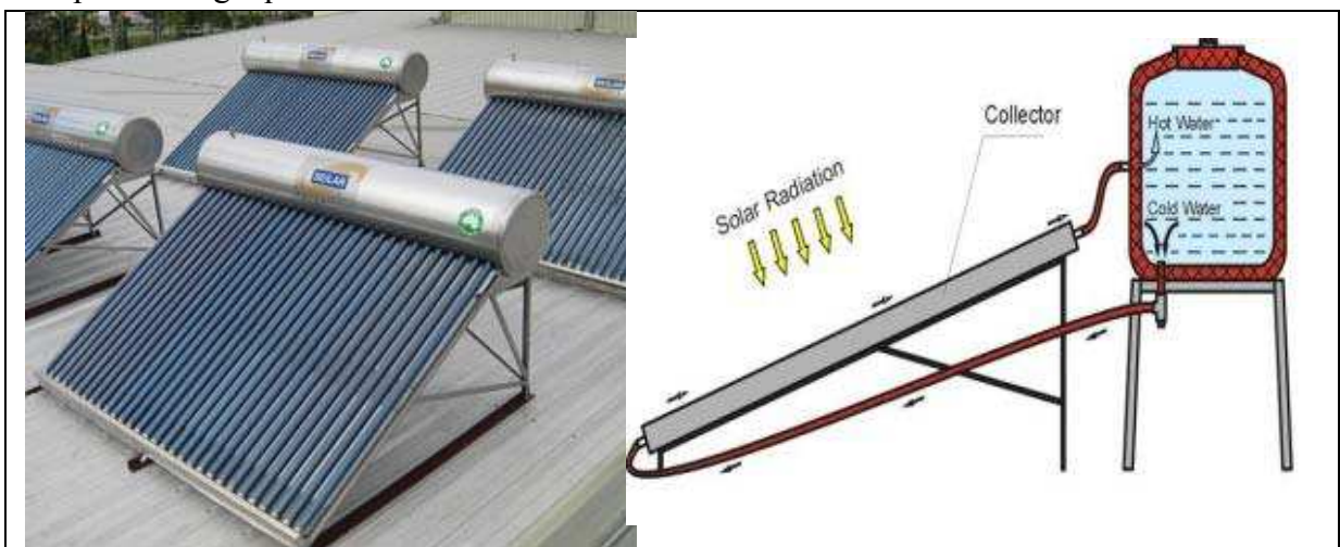
Figure 65: Le chauffe-eau solaire et son mode de fonction
