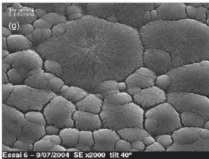
FIGURE 3.6.1: Une goutte d'une dispersion de 0.04%wt de Carbopol 940 neutralisée dans l'eau déminéralisée [45].
