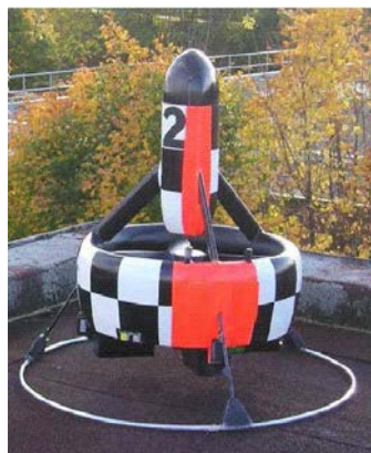
FIG. 1.8 – Le drone HoverEye de Bertin Technologies. (Hauteur 70 cm, diamètre 50 cm, propulsion électrique, 3 kg) [Pfimlin 06].
