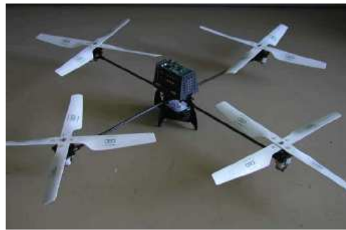
FIG. 1.11 – Le quadrirotor du projet ROBVOLINT. (Envergure : 50 cm).
