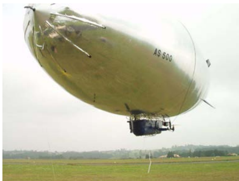
FIG. 1.12 – Le dirigeable Karma du LAAS (8 m de long, 15 \text{ m}^3 , 1.90 m de diamètre max.).
