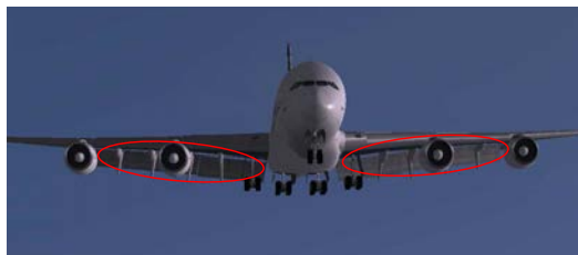
FIG. 3.15 – Volets sortis pour l'atterrissage : modèle de l'A380 dans le simulateur de vol Flight Simulator .
