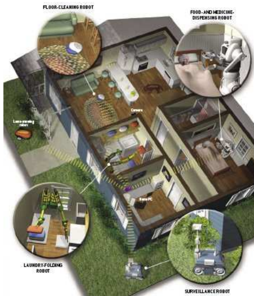
FIG. 1 – Une vision de la robotique personnelle [Gates 07] : plusieurs robots spécialisés sont affectés à des tâches spécifiques dans une maison domotisée qui coordonne l'ensemble.
