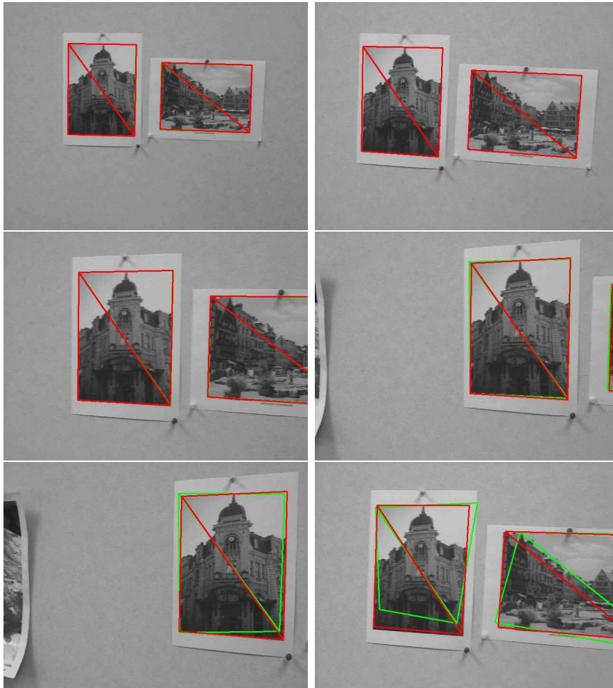
FIGURE 3.4 – Premier exemple d'occlusion avec le suivi Les contours des régions suivies sont affichés en vert et rouge, respectivement sans et avec l'aide des M-Estimeurs. Un meilleur suivi est observable avec les M-estimateurs.
